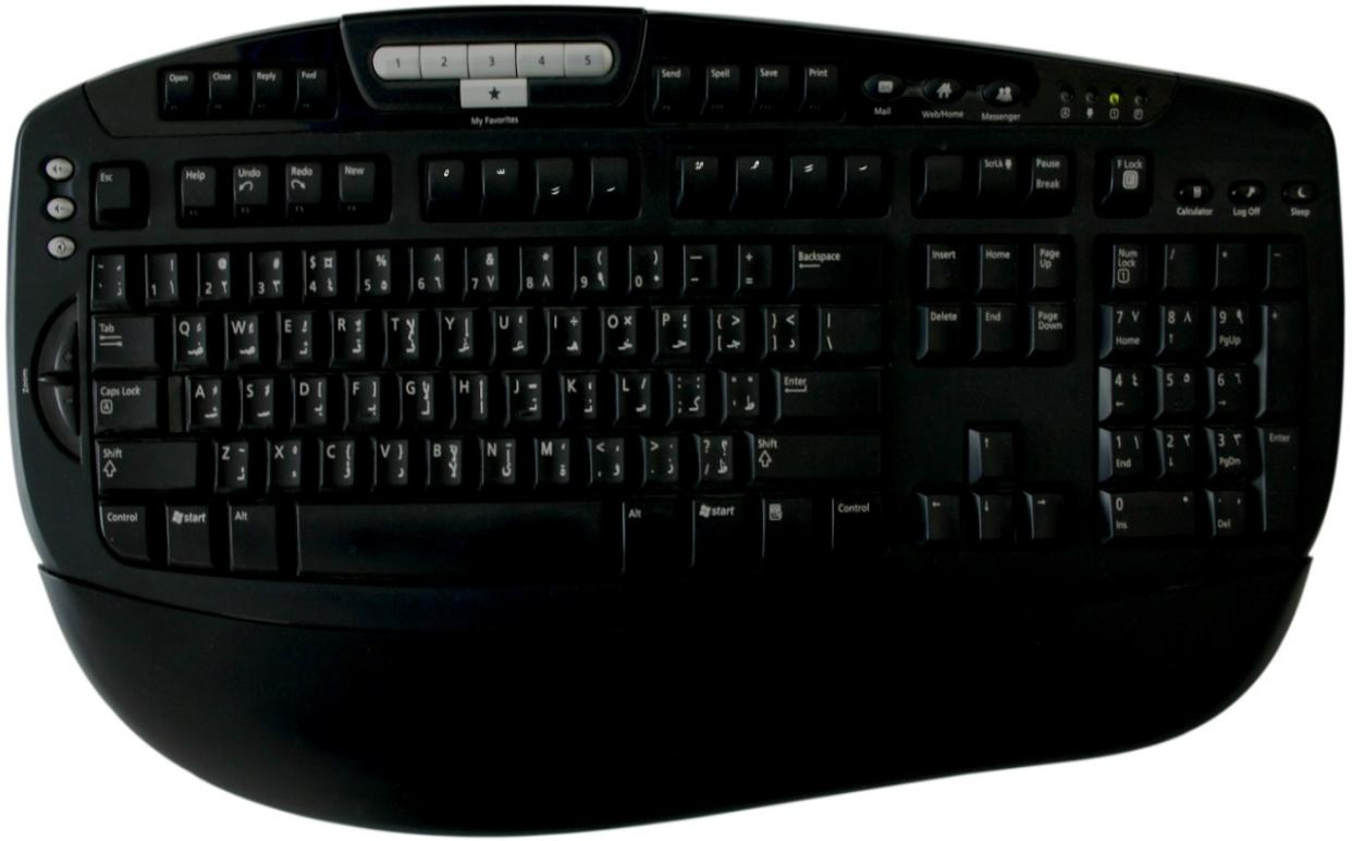
هذه صورة للوحة المفاتيح المقترحة كاملة، وقد أضيفت إلى اللوحة الأصلية مفاتيح خاصة بالحركات في أعلى اللوحة دون حذف شيء منها، وقد جاء موقعها قريباً من المفاتيح كثيرة الاستعمال؛ وذلك برفع مفاتيح قليلة الاستعمال سطرًا إلى الأعلى ووضعها مكانها.
